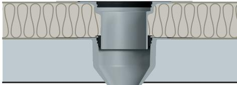
Beim Bestandssystem ermitteln an welcher Stelle saniert werden muss. Genügt eine Topfsanierung oder soll der neue SitaSani® Gully bis in das vorhandene Rohrleitungssystem geführt werden?
