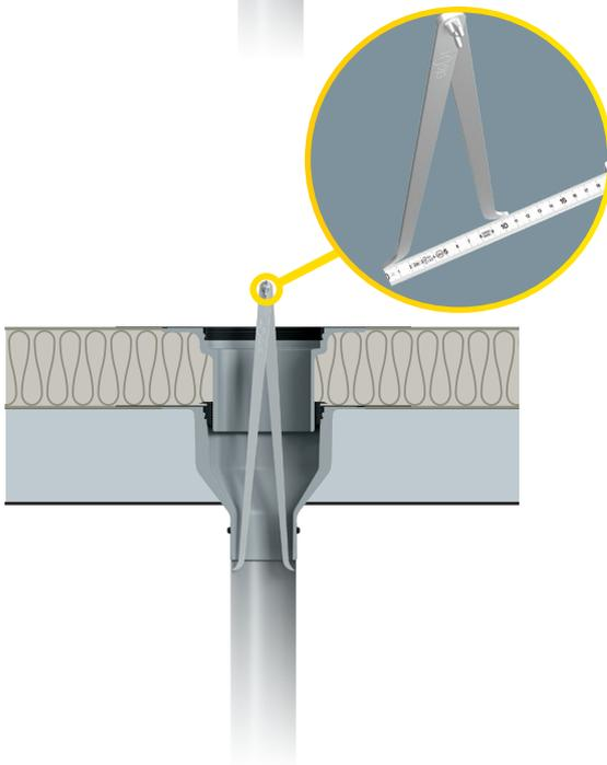
Den SitaSani® Innentaster an der gewünschten Stelle in den zu sanierenden Gully halten und auseinander schieben. Mit der Flügelmutter das Maß fixieren, aus dem Gully herausziehen und mittels Zollstock den ermittelten Innendurchmesser ablesen.
