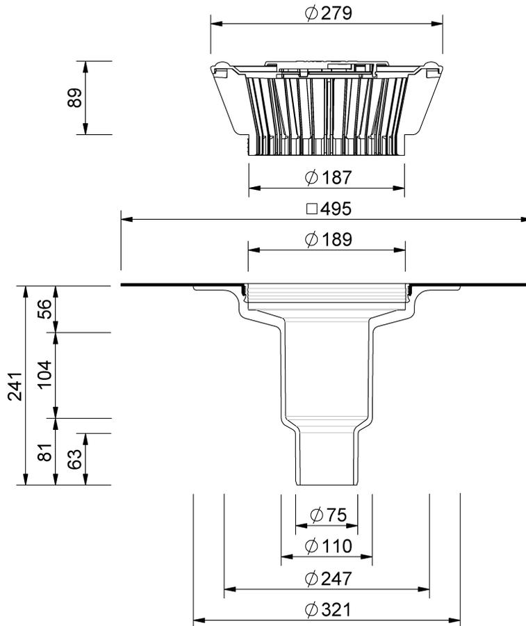
SitaStandard Stufengully, mit Polyfin 4020 v-Manschette
