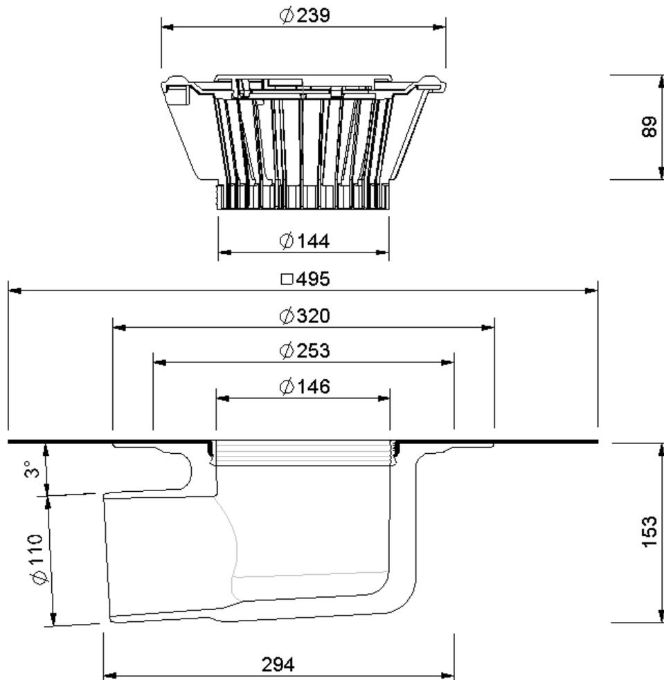
SitaTrendy abgewinkelt DN 100, mit Elevate QuickSeam SA Flashing-Manschette
