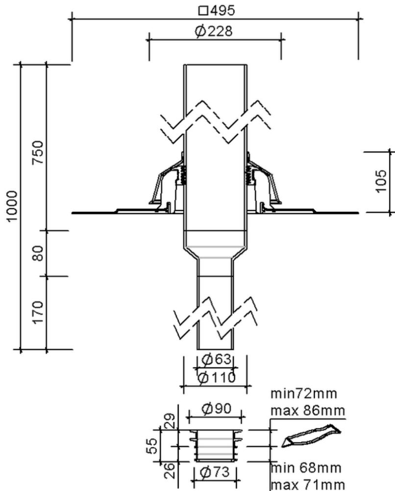
SitaVent Sanierungslüfter DN 63, mit Wolfin IB-Manschette
