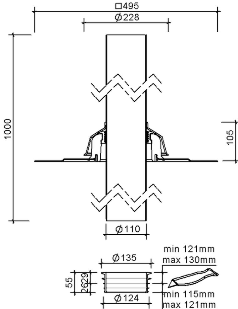
SitaVent Sanierungslüfter DN 110, mit VAEPLAN V-Manschette
