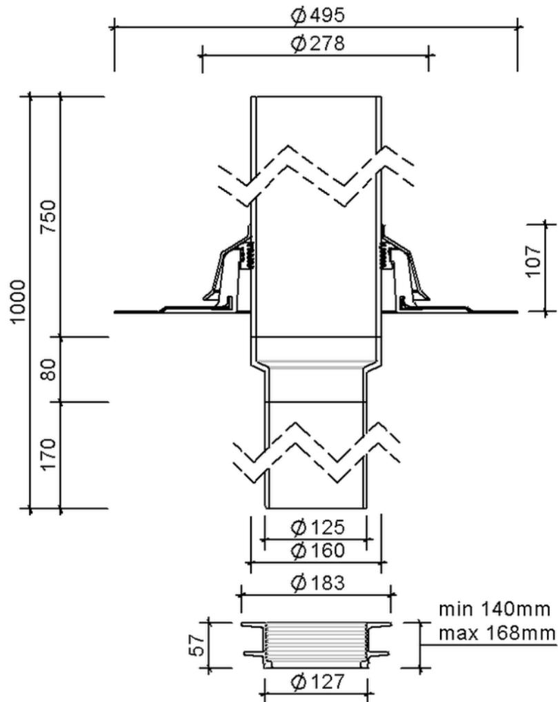
SitaVent Sanierungslüfter DN 125, mit Resitrix CL-Manschette
