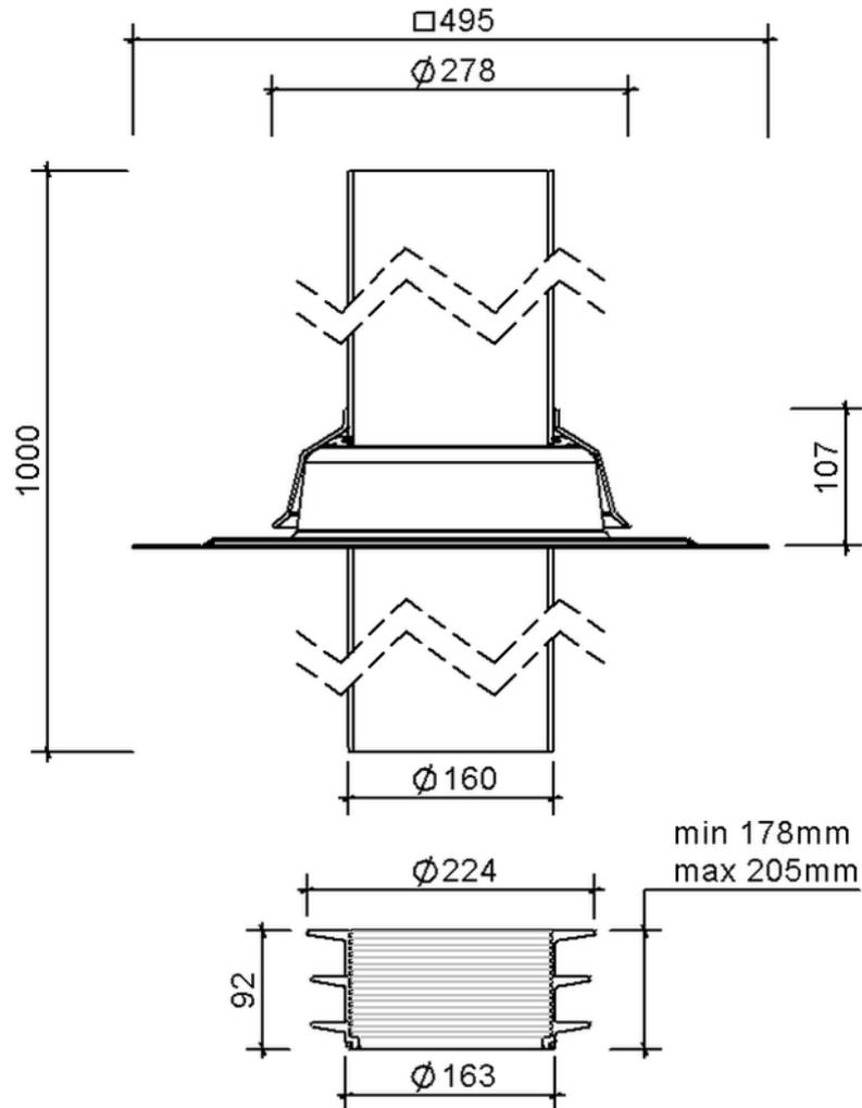
SitaVent Sanierungslüfter DN 160, mit Resitrix CL-Manschette
