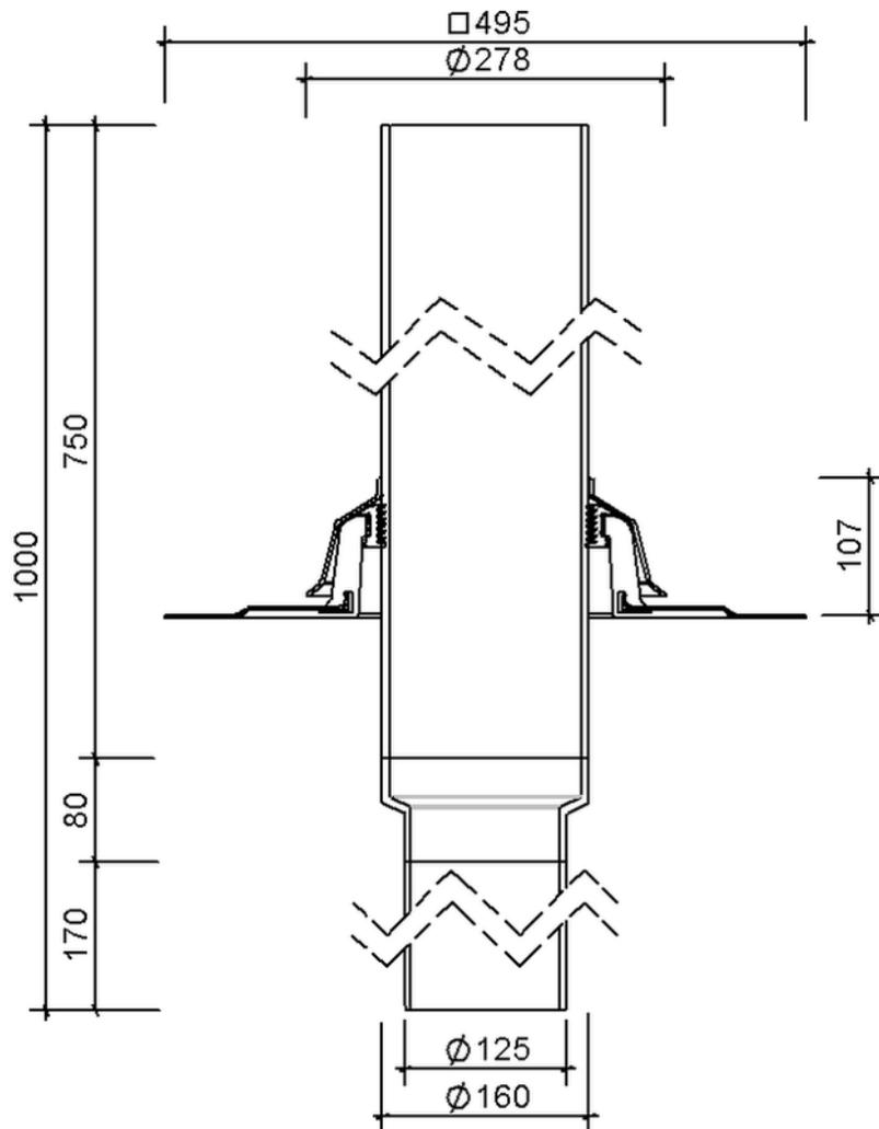
SitaVent Systemlüfter DN 125, mit Flagon EP basaltgrau-Manschete
