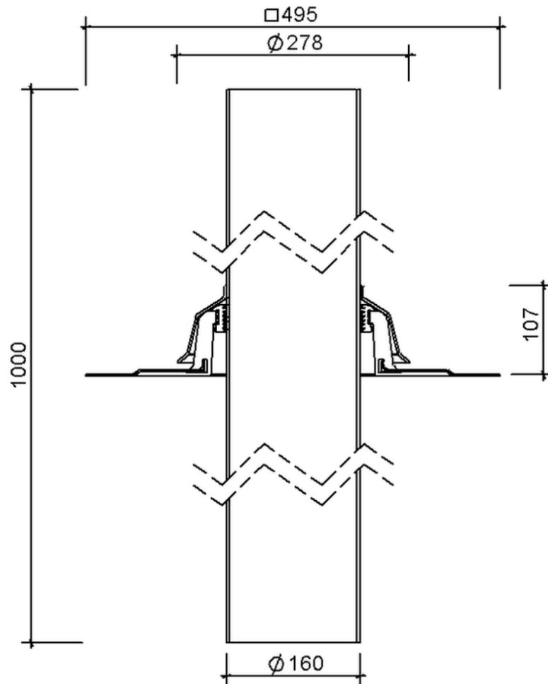
SitaVent Systemlüfter DN 150, mit Mapeplan T D-Manschette
