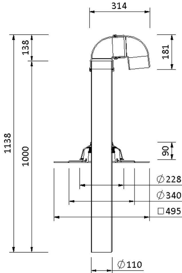
SitaVent Rohrdurchführung DN 100, mit Tectofin RV plus-Manschette
