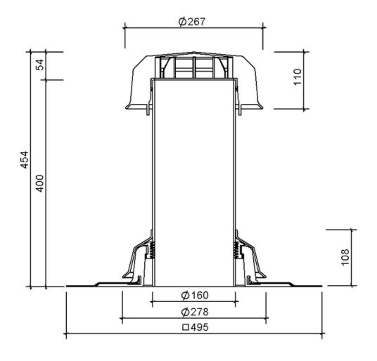
SitaVent Kaltdachlüfter DN 150, mit Wolfin IB-Manschette
