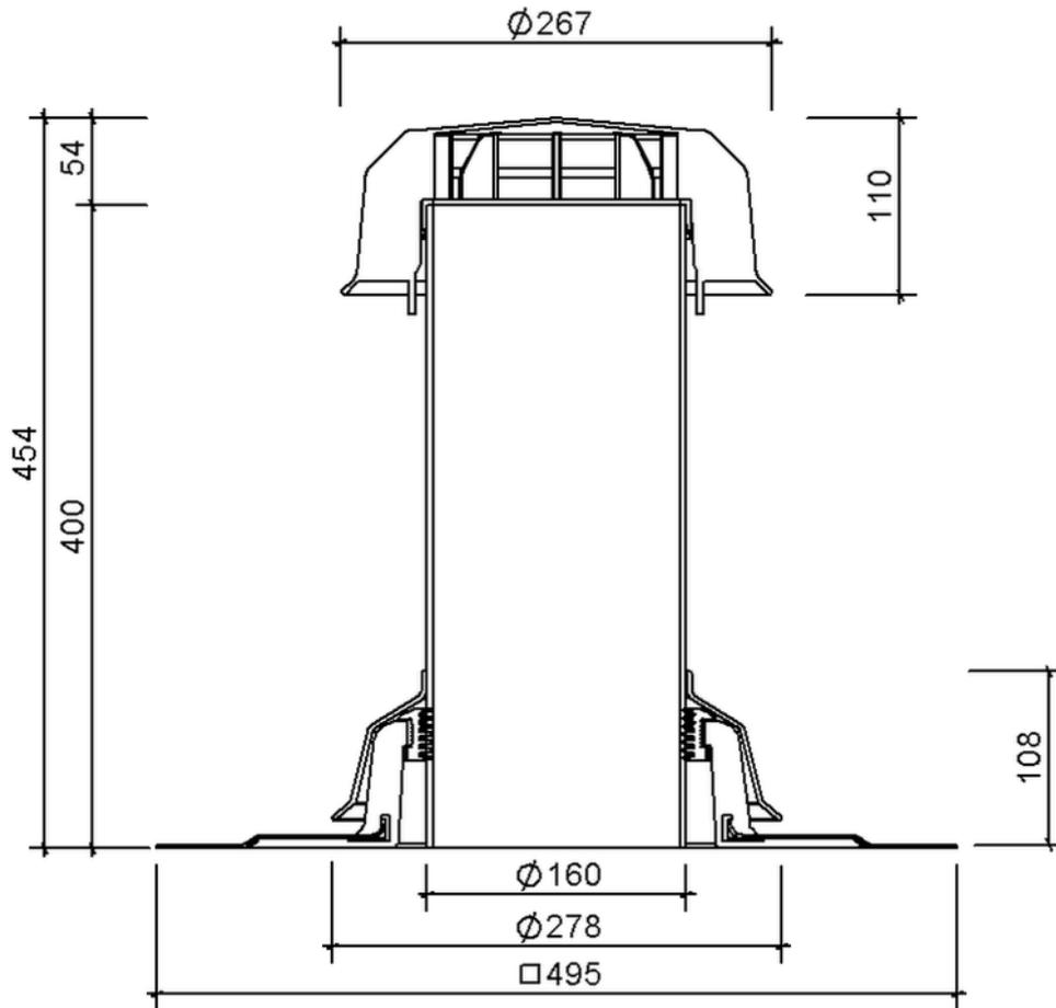
SitaVent Kaltdachlüfter DN 150, mit Elevate UltraPly grau-Man-
