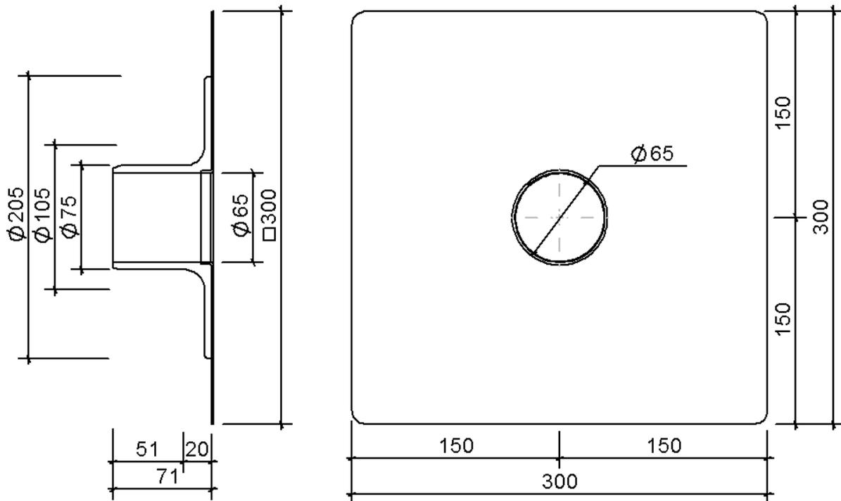
SitaEasy Plus DN 70, mit QuickSeam SA Flashing-Manschette
