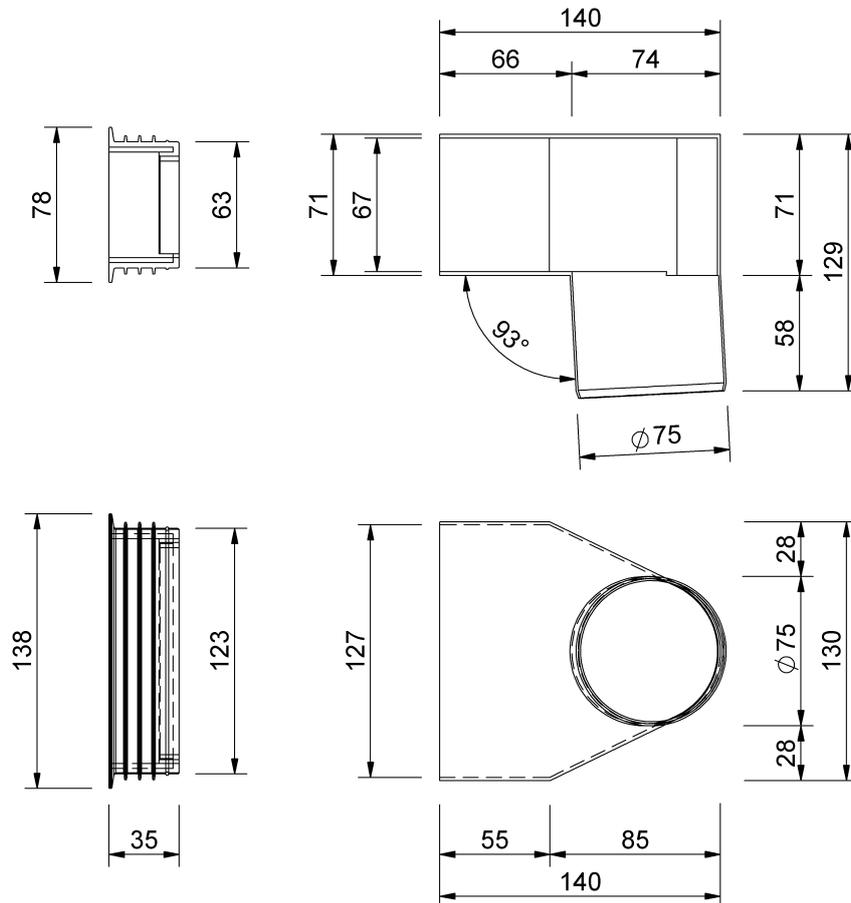
SitaTurbo Übergangsstück auf SitaPipe Edelstahl Rohr, auf SitaPipe
