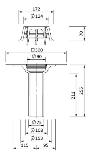
SitaCompact Near DN 70, mit NovoProof mit Fügefläche-Manschette
