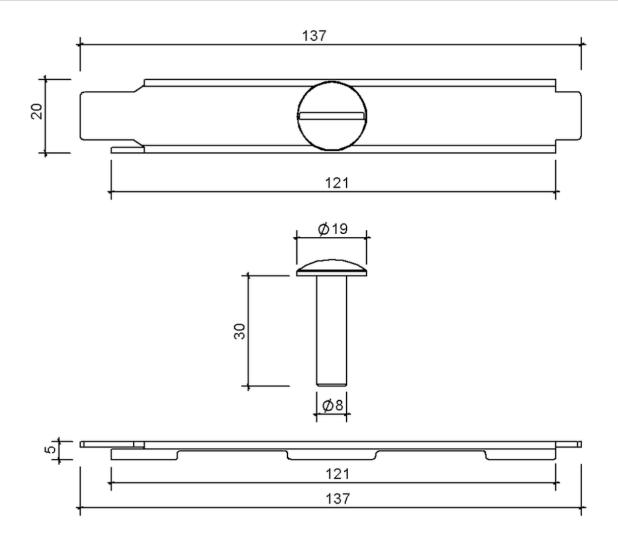
SitaDrain® Kastenrinne Befestigung für Gitterrost Stahl verzinkt, aus Edelstahl rostfrei
