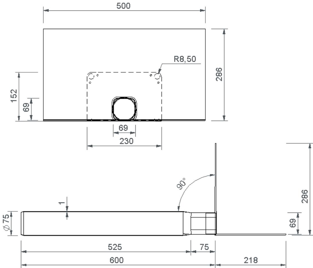
SitaSteel Attika quadrat DN 70, mit Bitumen-Manschette
